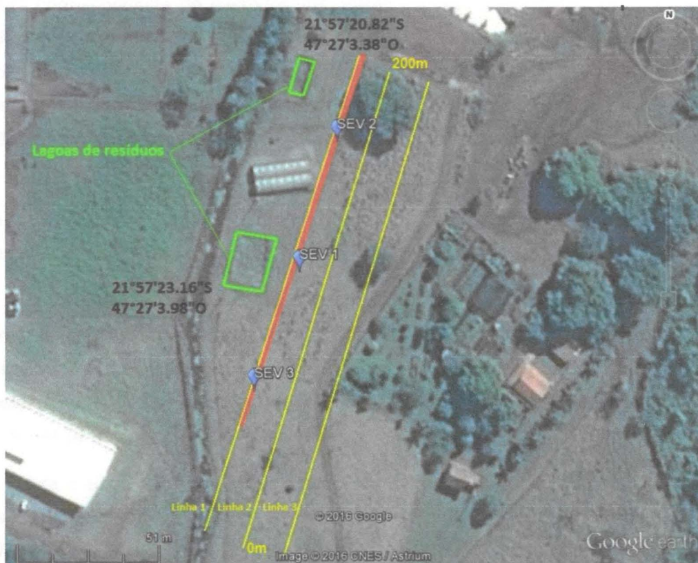
Figura 7.1 – Arranjo dos ensaios de campo a jusante das lagoas (em verde). Linhas em amarelo: CE com o aparelho SYSCAL; e linha em vermelho: CE com o aparelho ABEM; e estações das SEVs marcadas em azul.
